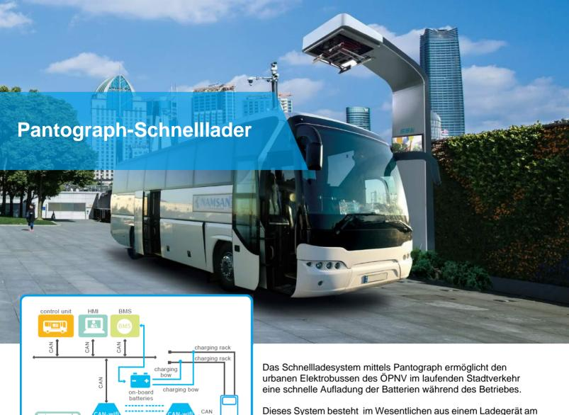
Boden, einem Ladebogen (Pantograph) , und einem Verbindungskabel, und einem ein WLAN-Modul usw. Das Fahrzeug wird mit dem Ladebügel mittel WIFI Signal verbunden, wenn der Ladevorgang notwendig ist. Der gleichgerichtete Ausgangsstrom wird über die Ladebügel dem Bus zugeführt. Der Stromabnehmer des Fahrzeugs steigt an und kontaktiert den Kollektor des Ladebogens um diesen aufzuladen.
